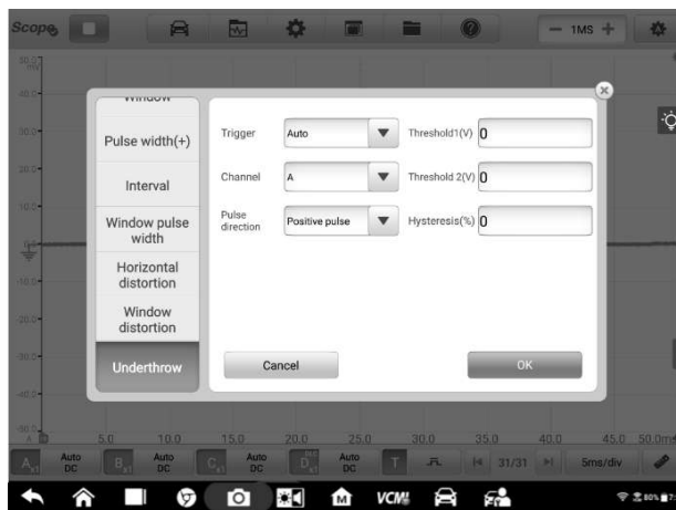
Figure 7-76 Exemple d'écran de paramétrage des sous-emplois
