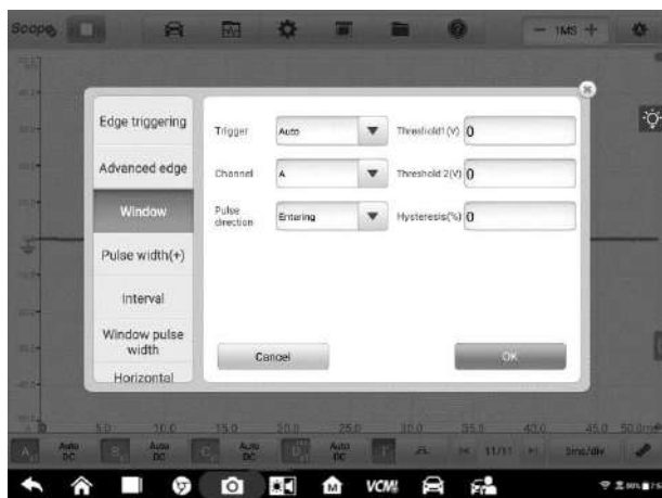
Figure 7-70 Exemple d'écran de paramétrage d'une fenêtre
