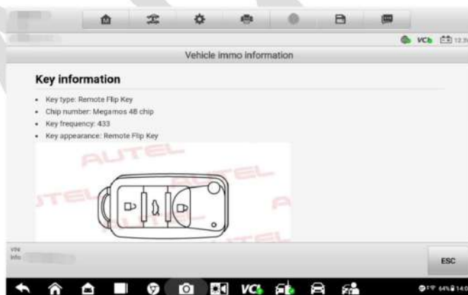
Figure 4-14 Écran d'informations IMMO du véhicule
