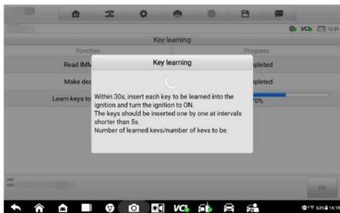
Figure 4-11 Écran d'apprentissage des touches 4
