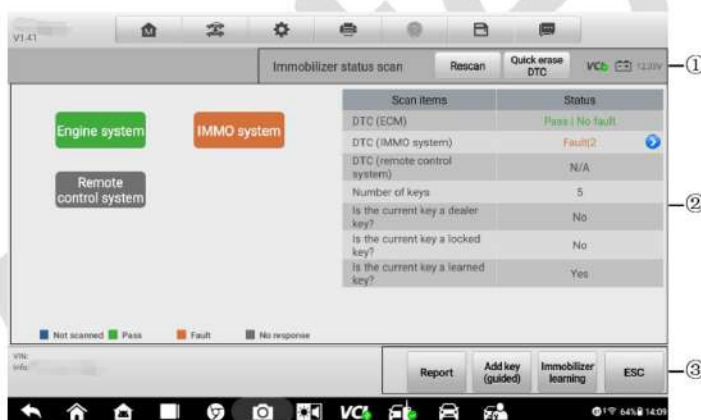
Figure 4-6 Écran d'analyse de l'état IMMO
